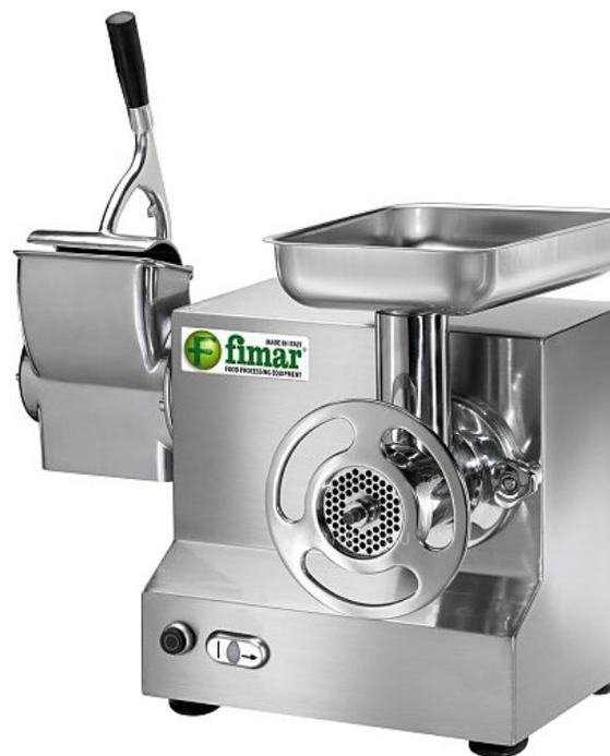
Мясорубка-терка **\*\*FIMAR 22/AT\*\*** предназначена для измельчения мяса и рыбы на фарш, повторного измельчения котлетной массы и набивки колбас на предприятиях общественного питания и торговли. Модель оснащена зубчатым редуктором в масляной ванне, микровыключателем на прижимном рычаге терки, нижней защитной решеткой и реверсом. Корпус, бункер, полностью извлекаемый режущий узел и ролик терки выполнены из нержавеющей стали, входное отверстие терки - из полированного алюминия
