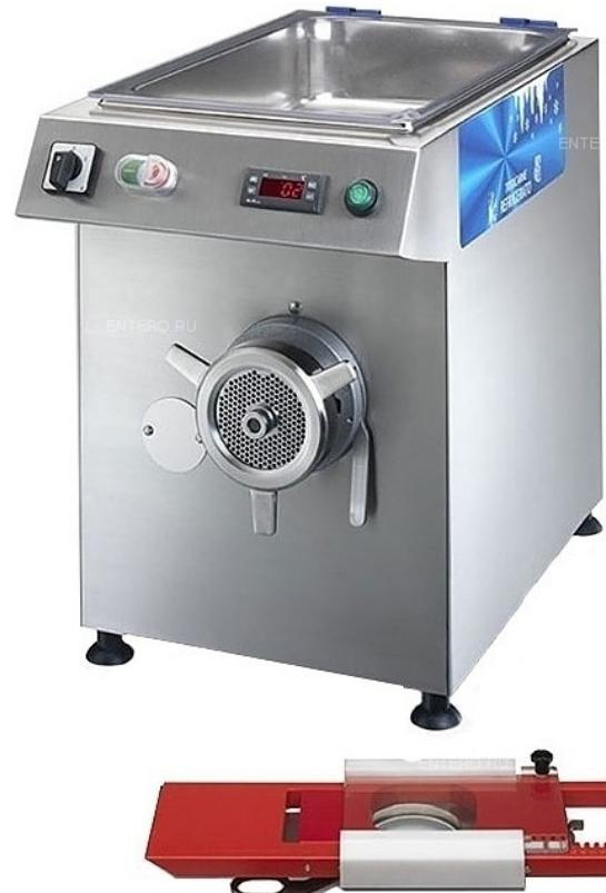
Мясорубка с охлаждением \*\*Minerva C/E R32H Enterprise 380 В\*\* используется на предприятиях общественного питания и торговли для приготовления мясного и рыбного фарша и колбасных изделий. Модель оснащена системой охлаждения, полуавтоматической насадкой для гамбургеров, одной самозатачивающейся решеткой и одним ножом. Корпус, загрузочный бункер, легко съемная горловина шнека выполнены из нержавеющей стали AISI 304, зажимное кольцо, решетка и нож - из нержавеющей стали.
